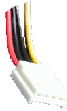
Conector alimentación floppy disk
