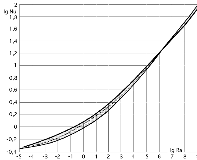
Fig XIV.8.- Correlación existente entre datos de convección natural hacia y desde cilindros horizontales
