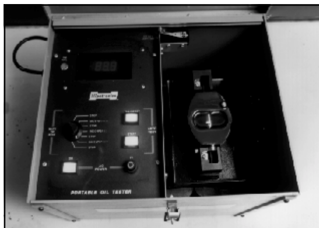
Figura 10.7 - Aparato utilizado para medir la rigidez dieléctrica de un aceite.
